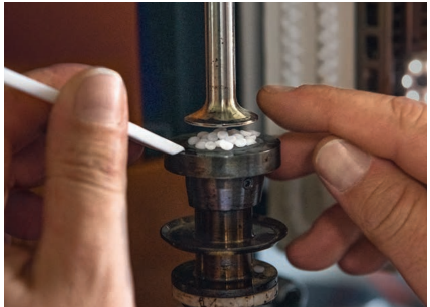
Im sogenannten Rheometer testet das Team, wie und ab wann sich Werkstoffe unter unterschiedlichen Bedingungen verformen.
